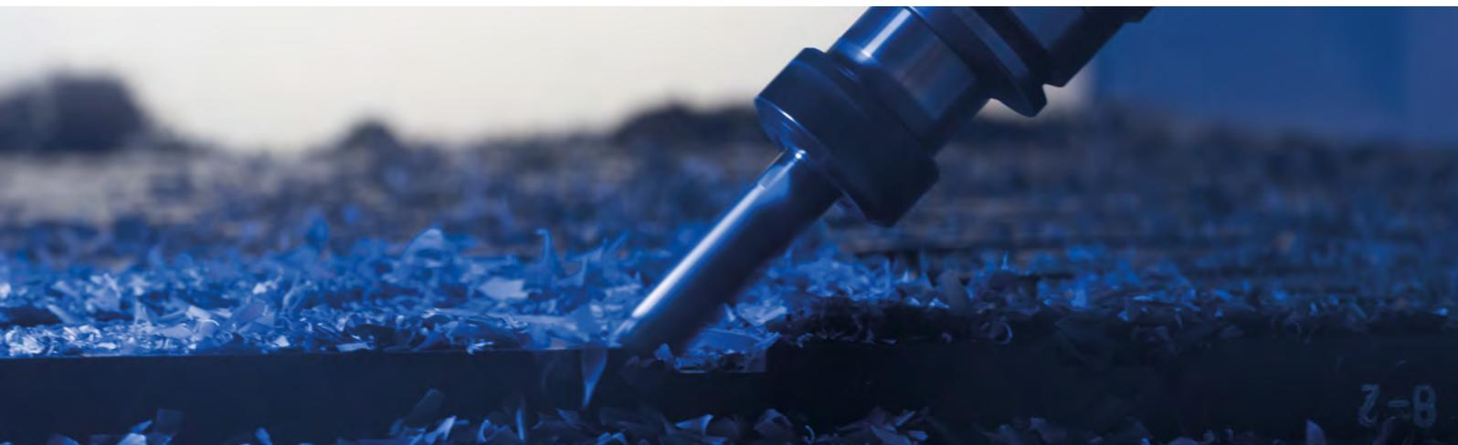
Nei prodotti **ZELLAMID®** rinforzati, per una maggiore resistenza sono incorporati nella matrice del materiale, fibre di vetro, fibre di carbonio, o cariche ceramiche. Le mutate proprietà meccaniche rappresentano una sfida durante la lavorazione.
