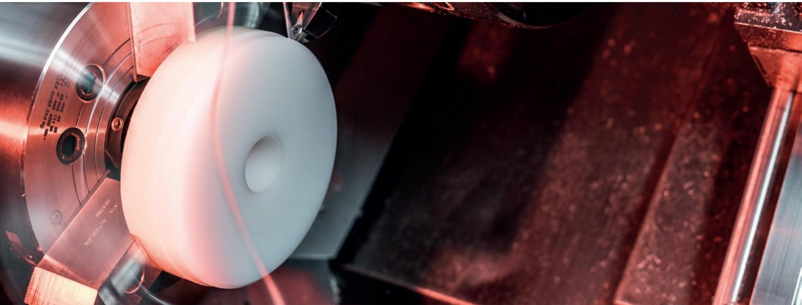
Da bei den meisten Kunststoffen ein Fließspan entsteht, ist auf eine besonders gute Abfuhr der Späne zu achten, da sich diese sonst einklemmen und mit dem Drehteil umlaufen. Des Weiteren ist aufgrund der geringeren Steifigkeit von Kunststoffen bei längeren Drehteilen die Gefahr des Durchhangs groß und deshalb die Verwendung einer Lünette ratsam.
