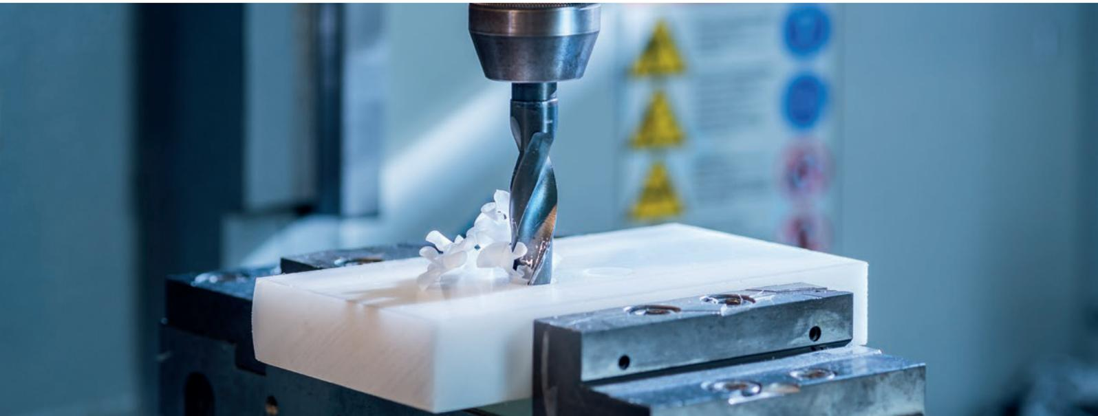
Bohrungen können mit handelsüblichen HSS-Bohrern hergestellt werden. Bei der Herstellung von tiefen Bohrungen ist darauf zu achten, dass für eine gute Spanabfuhr gesorgt ist, da es sonst an der Bohrungswand zur Erwärmung des Kunststoffes bis zur Schmelztemperatur kommen kann und der Bohrer „schmiert“. Dies gilt insbesondere für tiefe Bohrungen.
